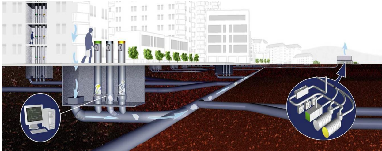
Kuva 8-3 Imukeräysjärjestelmä teknisenä rakenteena. (Isoaho, 2009)
