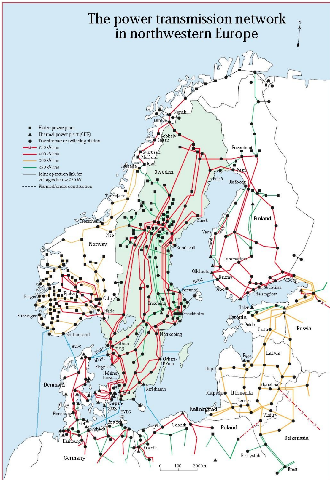
Kuva 1-1. Pohjoismaiset sähkönsiirron kantaverkot. Alkuperäinen kartta on vuodelta 2003 (Svenska Kraftnät) ja sitä on päivitetty löydettyillä tiedoilla vuoden 2003 jälkeen valmistuneista siirtolinjoista (Fingrid). Liettuan Ignalinan ydinvoimala on suljettu vuonna 2009. Kartta ei välttämättä ole kaikilta osiltaan ajan tasalla.
