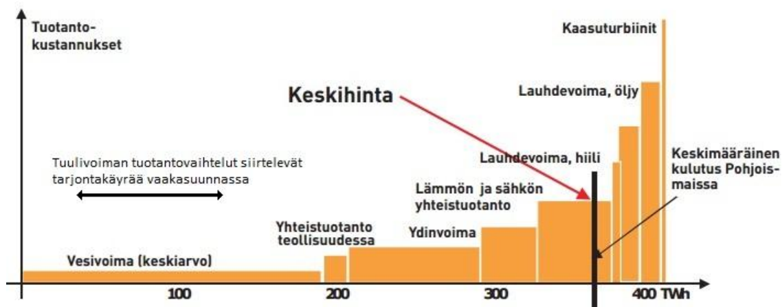
Kuva 3-1. Sähkön markkinahinnan teoreettinen muodostumismekanismi sähköpörsissä (muokaten: Fingrid-lehti 1/2009).
